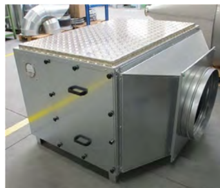
Filtergehäuse FG 12000 Mit Differenzdruckanzeige, stapelbar, beiderseits Inspektionsöffnungen zum Wechseln der Filter. Geeignet für Außenaufstellung.
