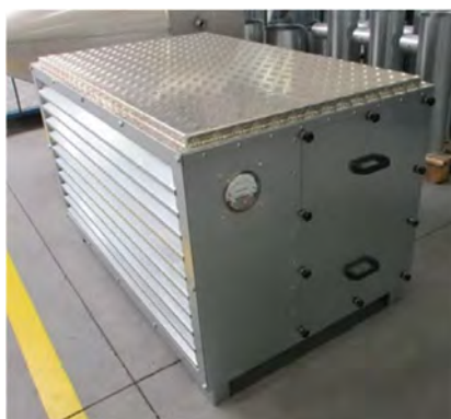
Filtergehäuse FG 12000 Mit Differenzdruckanzeige, stapelbar, beiderseits Inspektionsöffnungen zum Wechseln der Filter. Geeignet für Außenaufstellung.
