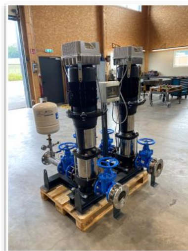
HSHG-Druckerhöhungsanlage mit Frequenzumrichtern
